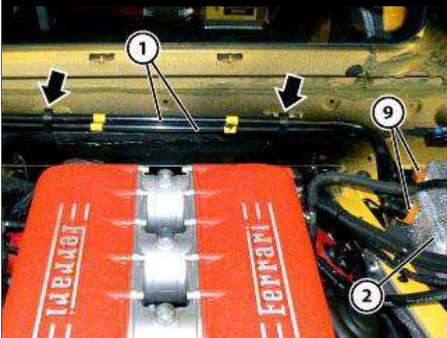
在将快换接头管 (1) 正确连接至右侧燃油箱 (2) 之后，小心按压指示的“双锁”型夹子 (9) 两侧，将夹子压入其底座中，直至听到它们卡接到位并且管正确固定。
