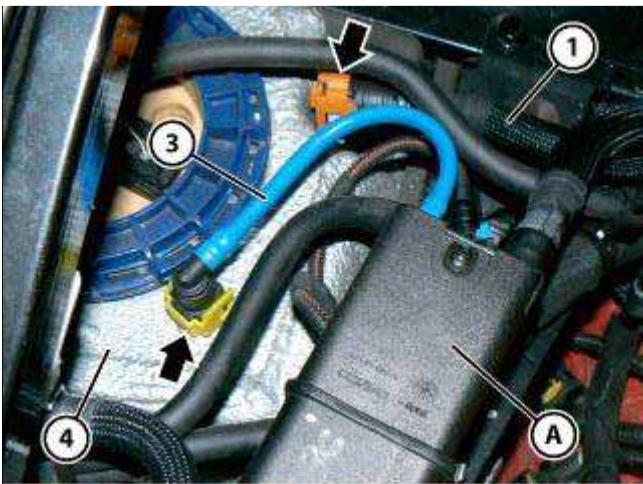
在将燃油蒸汽分离器 (A) 的快换接头管 (1) 和 (3) 正确连接至左侧燃油箱 (4) 之后，小心按压指示的“双锁”型夹子两侧，将夹子压入其底座中，直至听到它们卡接到位并且管正确固定。
